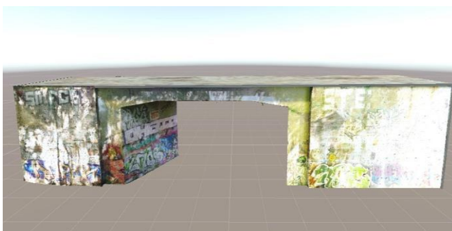
Abb. 2: Durch Laser-Scanning und Photogrammetrie erzeugtes Modell
